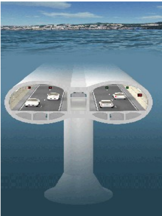
Σχήμα 2. Υποθαλάσσια σήραγγα (α) εδραζόμενη επί πυλώνων εκ σκυροδέματος, (β) αναρτημένη εκ κιβωτίων βάρους εδραζόμενων εις τον πυθμένα της θαλάσσης.
