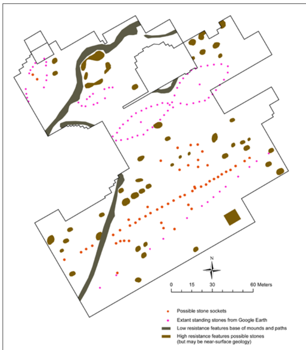
Figur 5. De tolkade resultaten av resistivitetsmätningarna vid Anundshög. Stolpmonumentet utgörs av raden med prickar i orange färg i områdets södra del.
